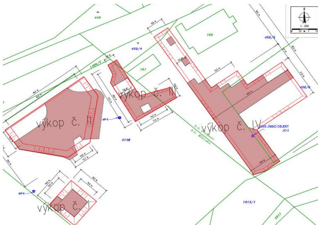
Obr. 3: Rozsah prací ve výkopech č. 1–4
