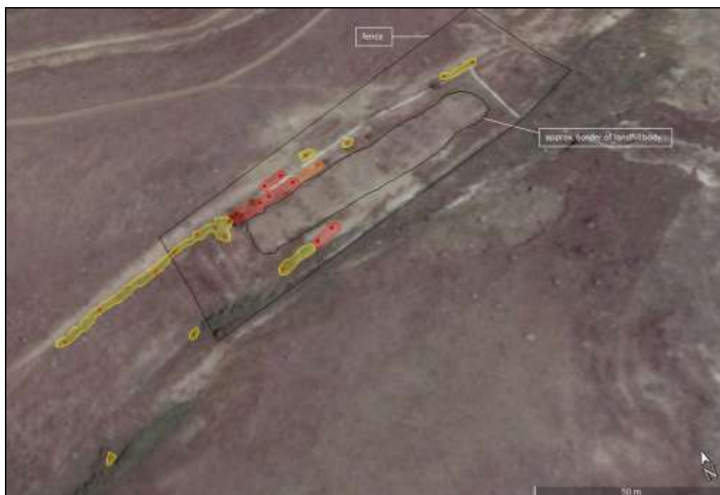
Obr. 5: Výsledek průzkumu – odhad rozsahu a úrovně povrchové kontaminace v okolí skládky organochlorových pesticidů na základě výsledků naměřených ED-XRF spektrometrem DELTA
