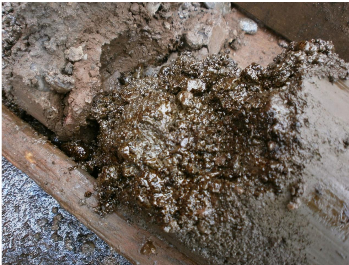
Obr. 3: HPV-3, kontaminace při bázi kvartéru – detail, senzorická kontaminace v hloubkové úrovni 11,6 m p.t.
