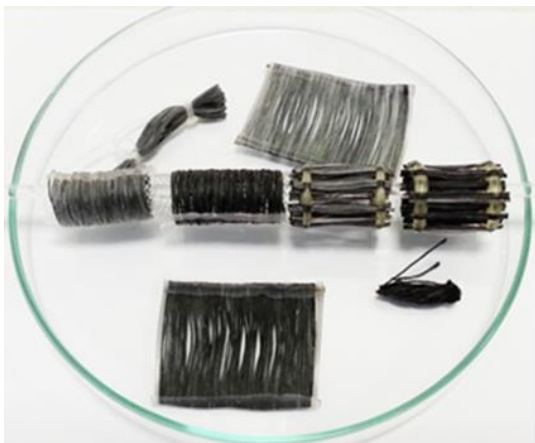
Obr. 2: Fotografie různých tvarových uspořádání testovaných nanovláknenných nosičů
