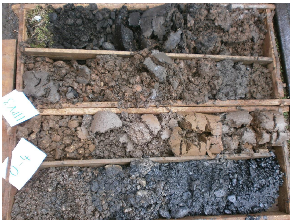
Obr. 2: Vrt HPV-3, hloubkový interval 0–4m, fotodokumentace vrtného jádra
