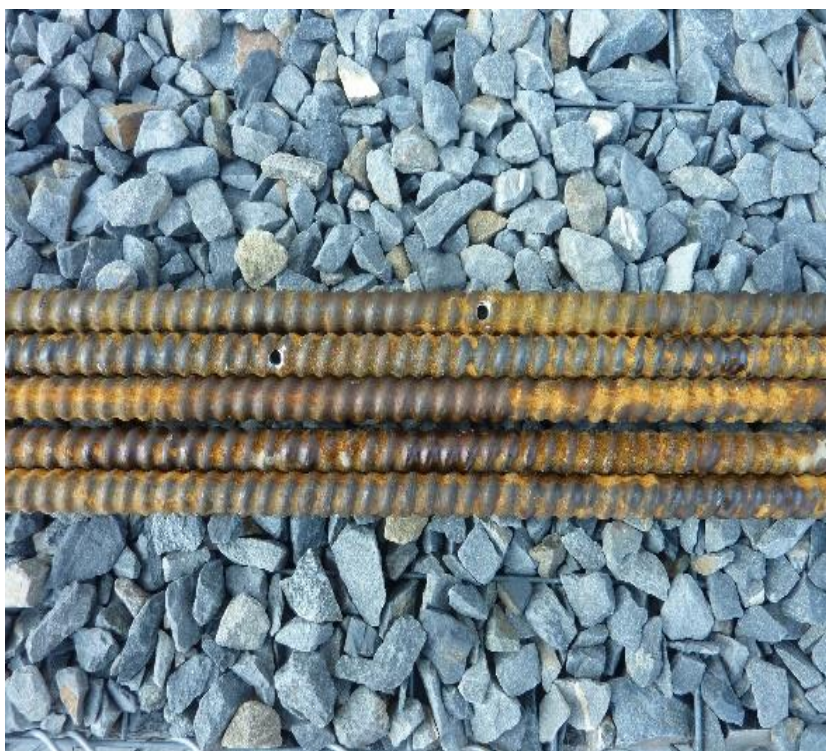
Obr. 4: Pohled na IBO svorníky a detailní pohled na perforaci
