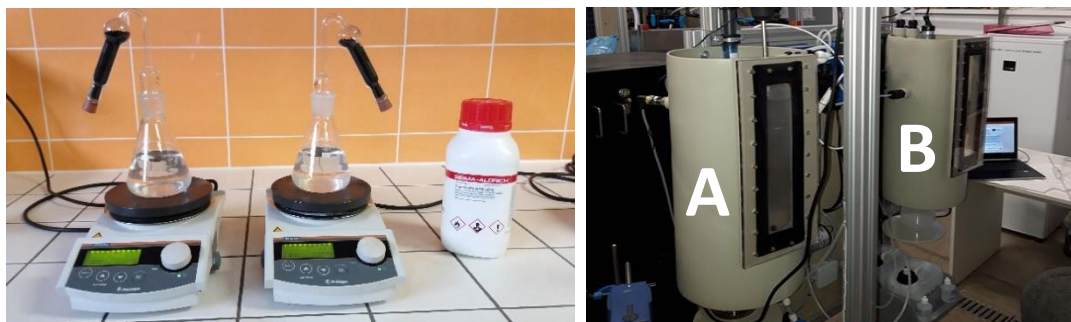
Obr. 1 a 2: Schéma usporiadania laboratórnych dehalogenačných testov (vľavo) a štvrt'prevádzky v spoločnosti ASIO, spol. s.r.o. (vpravo)
