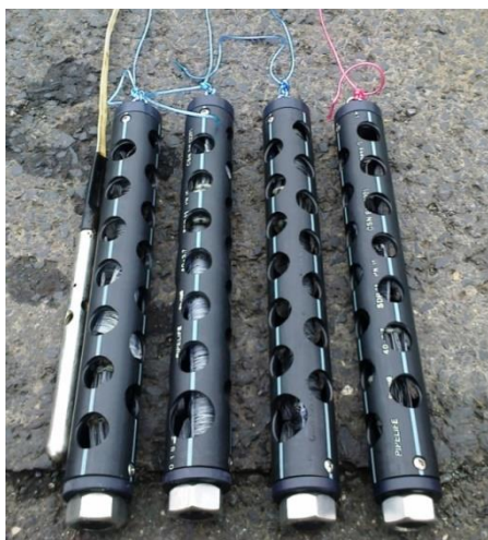
Obr. 1: Vzorkovací patроны využívané pro zanoření nanovláknenných nosičů biomasy na zkoumaných lokalitách
