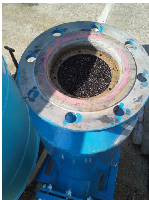
Obr. 4: Schéma funkční kolony a fotografie naplněné kolony nanomateriálem
