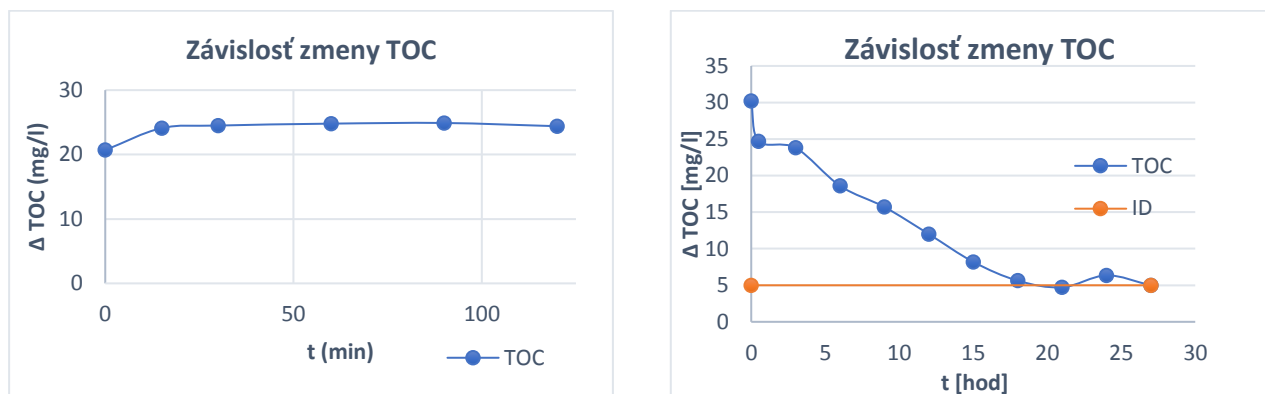
Obr. 1: Zmena TOC pri fotooxidácii, zľava pri trvaní 120 min a zprava pri čase 27 hodín- až do úplného rozkladu peroxidu vodíka. ID predstavuje hodnotu indikačného kritéria 5 mg/l.
