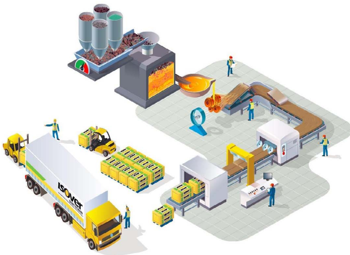
Obr. 3 – Schéma výroby minerální vlny
