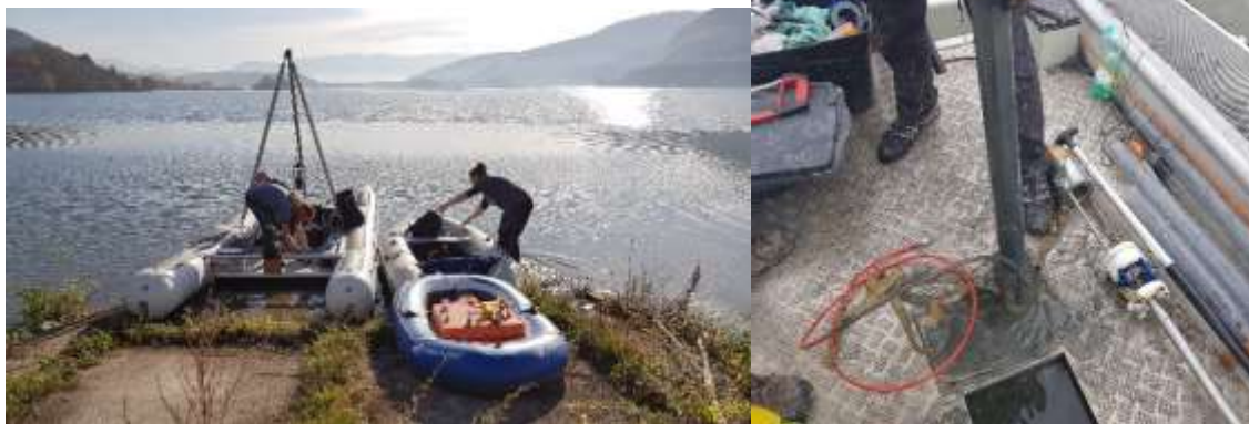
Obr. 3.: Plovoucí vrtná platforma a odebírání vrtného jádra ze dna přehrady
