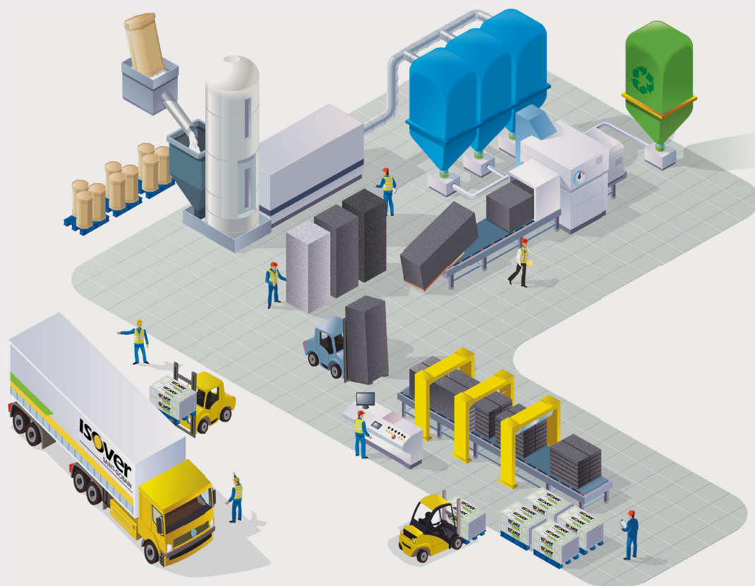
Obr. 3 - Schéma výroby pěnového polystyrenu
